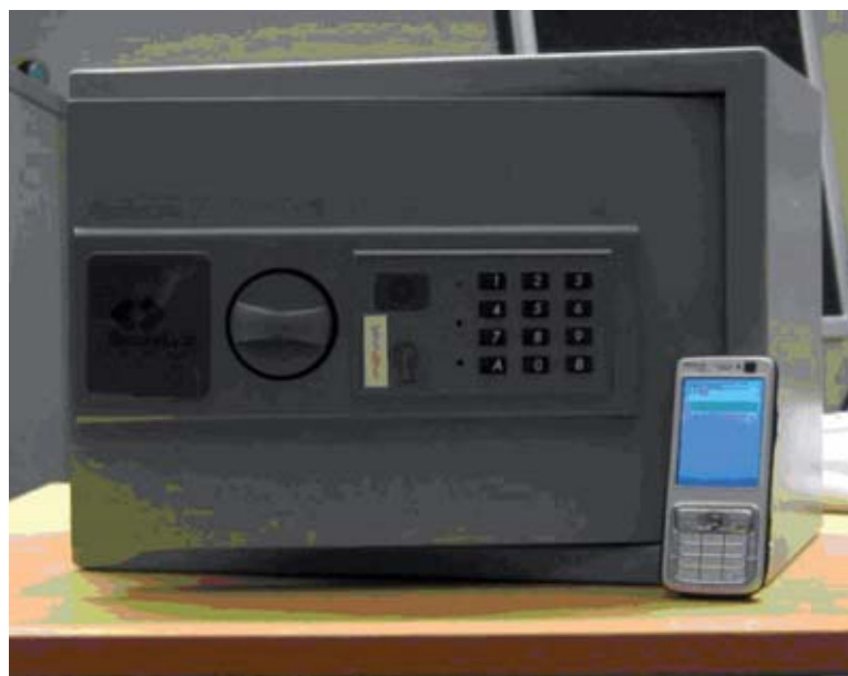
Kuva 40. Turvalääkekaappi, jossa on Mohinet Oy:n SecLoc lukitusjärjestelmä.
